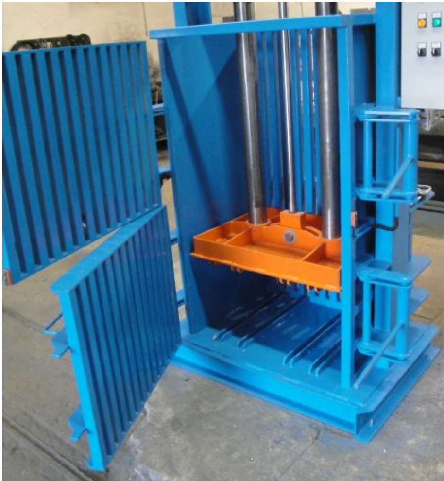
Otevřená lisovací komora – vodící tyče a drážky pro vázání
