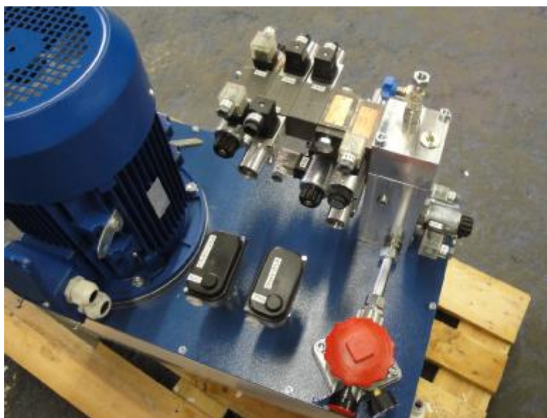
Uspořádání hydraulických prvků na víku nádrže
