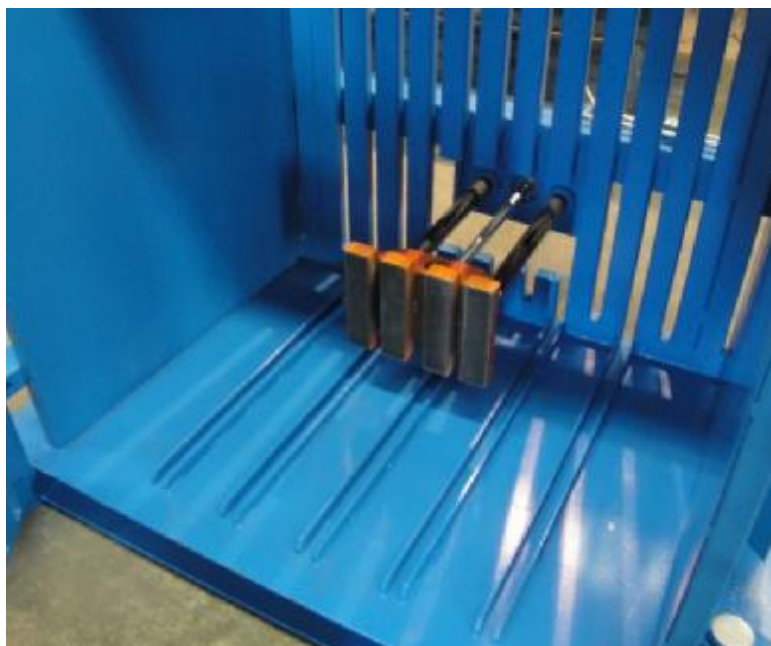
Vnitřek lisovací komory s vysunutým vyhazovačem
