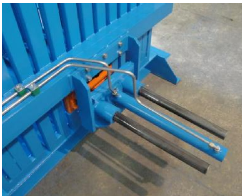
Hydraulický válec a vodící tyče vyhazovače balíku
