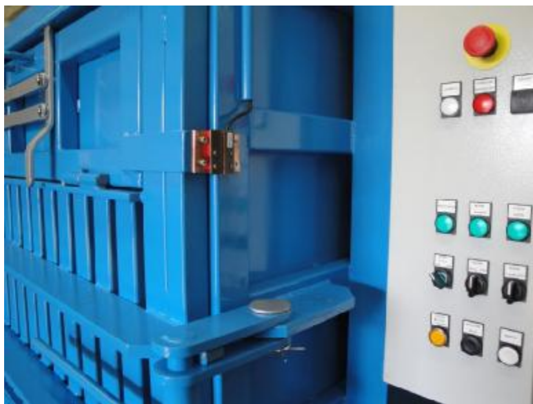
Uzavírání komory a kontrolní magnet uzavření
