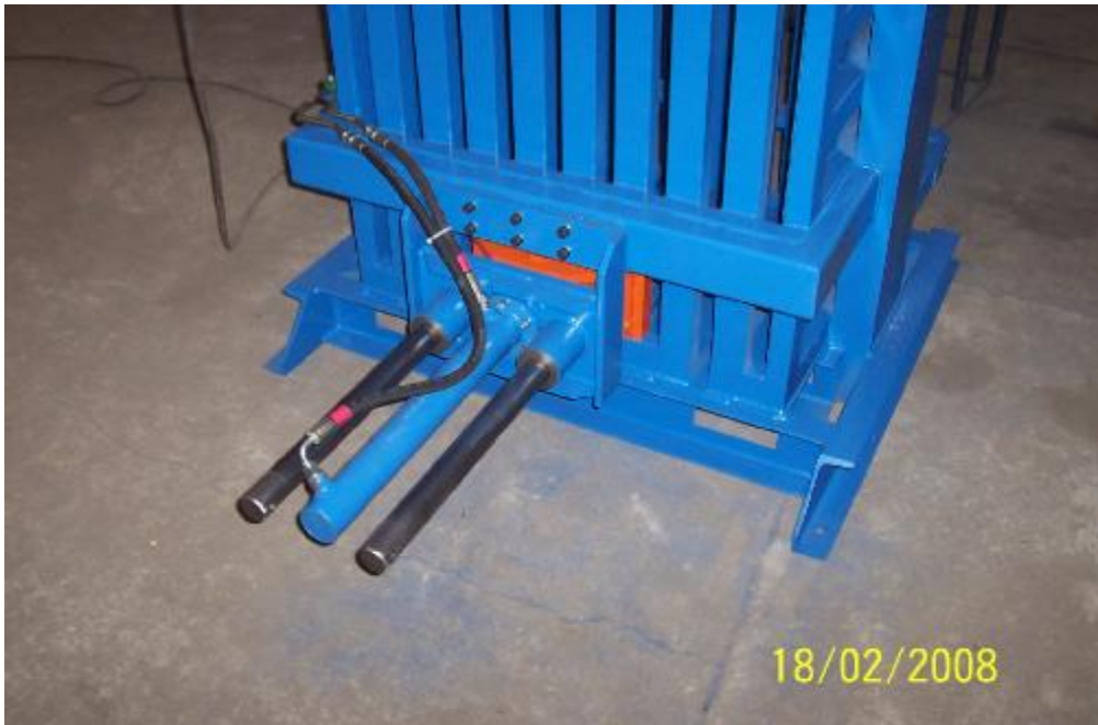
Vyhazovač balíku v zadní části lisu
