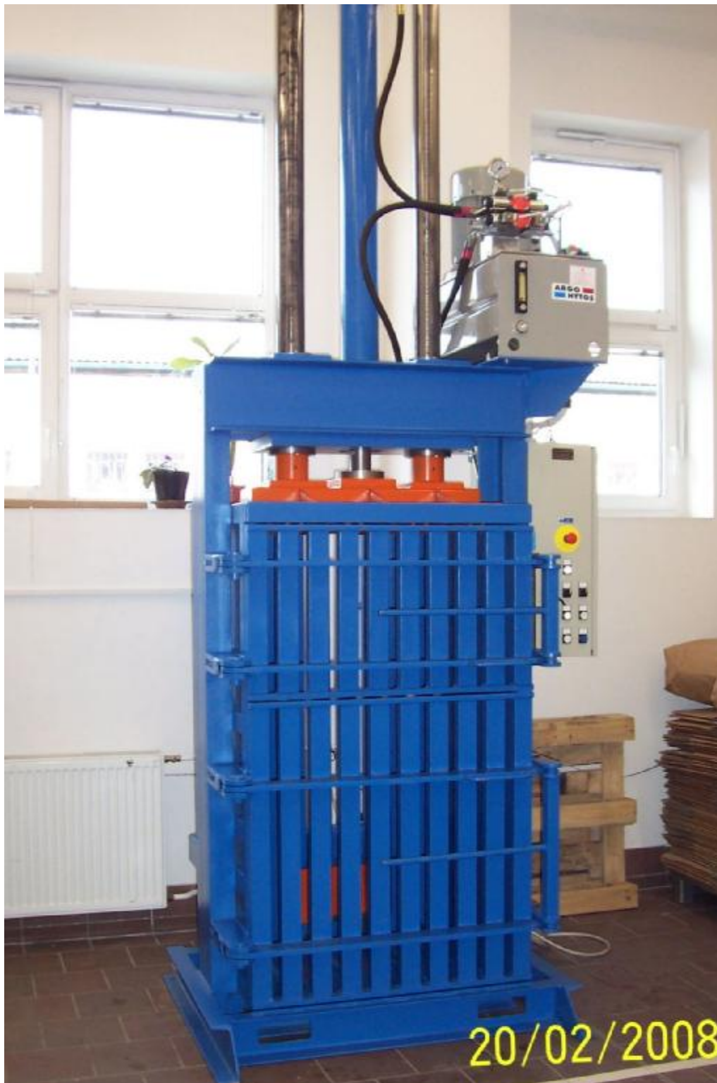
Hydraulický paketovací lis HPL 12
