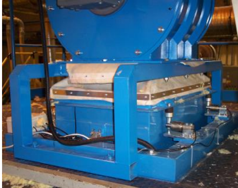
Zhora rotační podavač, připojení na vstup vážící násypky, detail tenzometrických snímačů .
