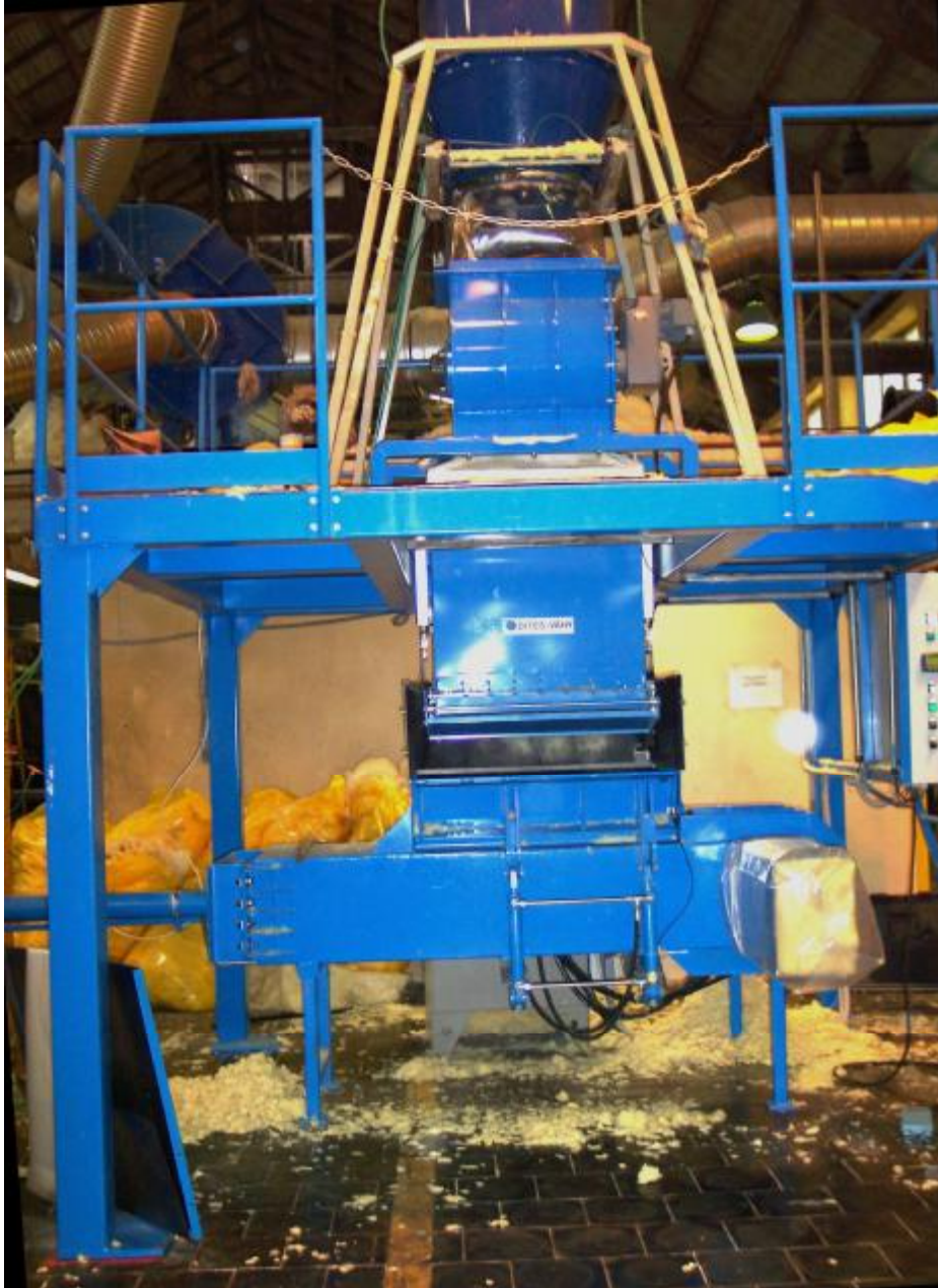
Sestava zařízení – zhora: cyklon, rotační podavač, váha, vlastní lis
