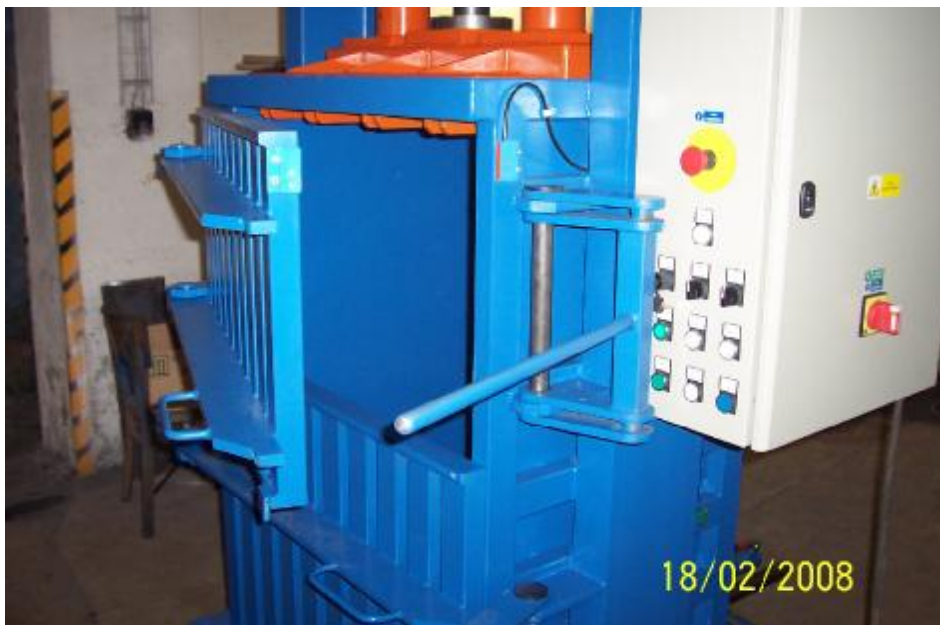
Uzavírání lisovací komory a ovládací prvky na rozvaděči
